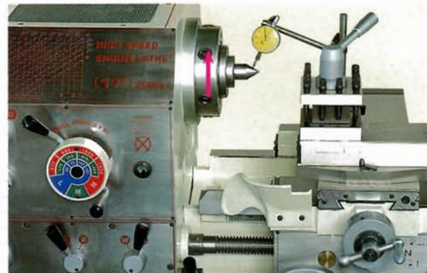
Spindle center runout A:0.0002" B:0.0004"
